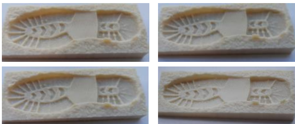
Obrázok 9 Výsledné výtlačky 3D modelov trasologickej stopy pri použití rôznych nastavení množstva výplne (zľava doprava zhora nadol 5 %, 25 %, 50 % a 80 %)
