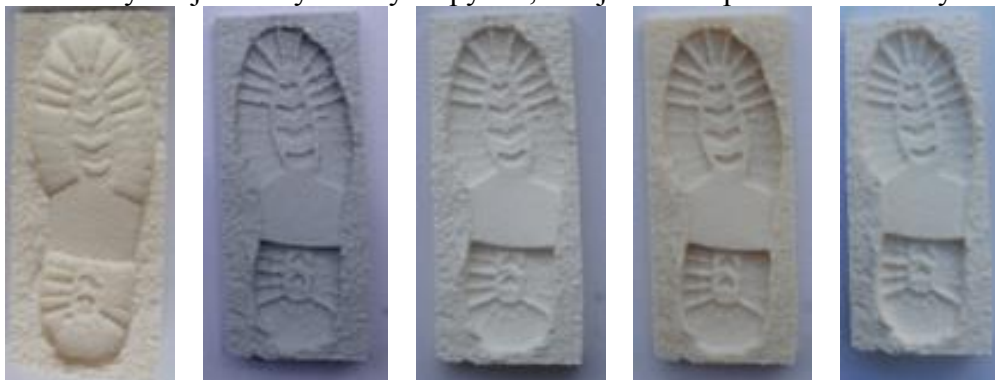
Obrázok 8 Výsledné výtlačky 3D modelov trasologickej stopy pri použití rozdielnych filamentov (zľava doprava materiál PLA, PET-G, ABS, ASA, FiberFlex)
