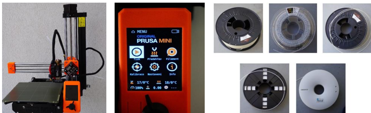
Obrázok 2 Zľava - 3D tlačiareň Original Prusa Mini+, ovládací panel na 3D tlačiarne, materiál na tlačenie PLA, PET-G, ASA, ABS, FIBER FLEX (zľava doprava zhora nadol)
