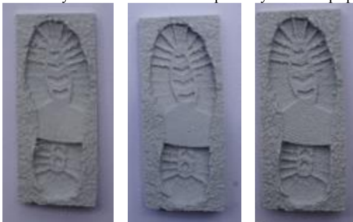
Obrázok 13 Výsledné výtlacky 3D modelov trasologickej stopy pri použití rôznej hrúbky vrstiev (filament PET-G) (zľava doprava 0,10 mm, 0,15 mm, 0,25 mm)
