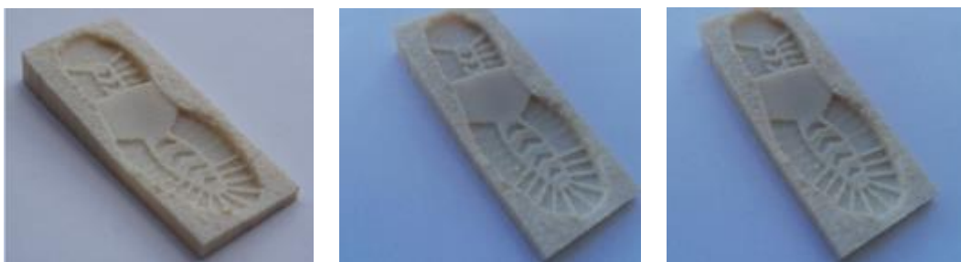
Obrázok 11 Výsledné výtlacky 3D modelov trasologickej stopy pri použití rôznych typov výplne (zľava doprava gyroid, stars a hilbert curve)
