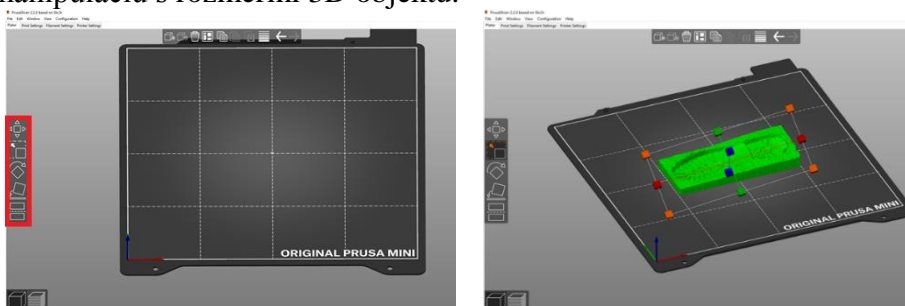
Obrázok 4 Import a veľkostná úprava modelu trasologickej stopy v programe Prusa Slicer
