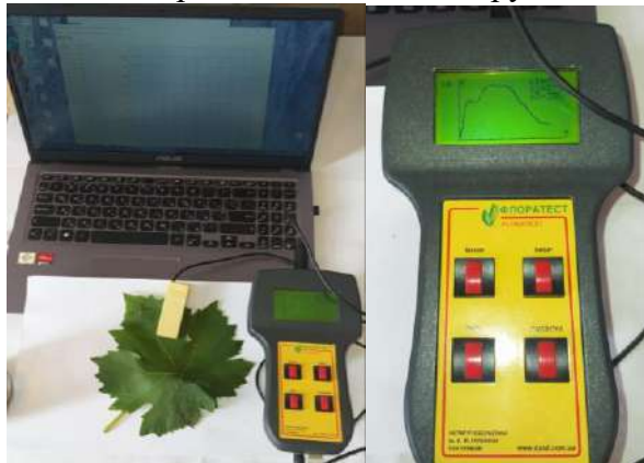
Рис 1. Портативный хронофлуорометр «Флоратест», разработанный институтом кибернетики им. В.М. Глушкова НАН Украины [8].
