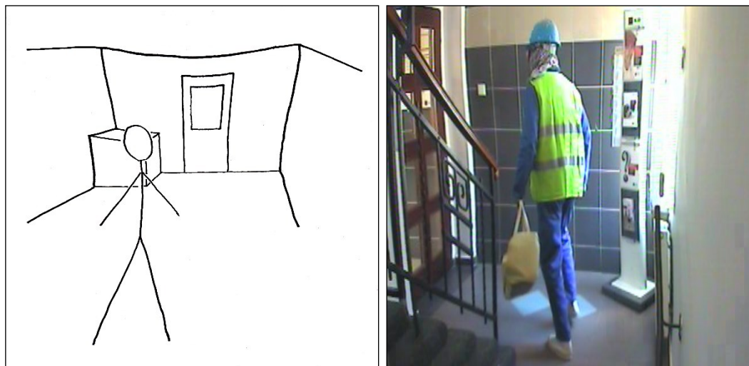
Obr. 34 Schéma „poduškového“ zkreslení 2 a praktický příklad z kamerového záznamu 74
