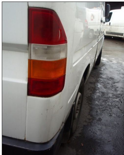
Obr. 54 Rozhraní bílé a červené části krytu koncové svítilny 87
