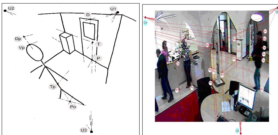
Obr. 32 Schéma tříúběžníkové perspektivy a praktický příklad z kamerového záznamu 72
