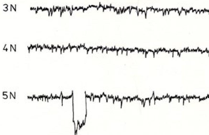
Obr. 48: Profilogramy hutního materiálu (nerezavějící ocel) při odstupňované působící síle
