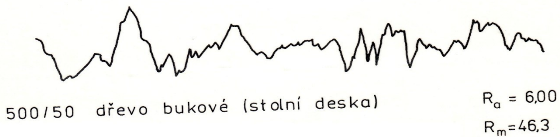
Obr. 54: Ukázka profilogramů odražejících objektů (různé materiály)
