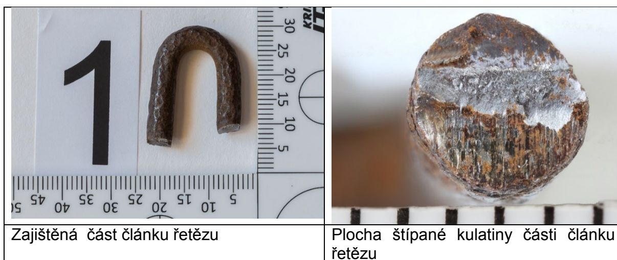
Obr. 69: Zajištěná mechanoskopická stopa (Řenč, Šebák, Uher OKTE Policie ČR)
