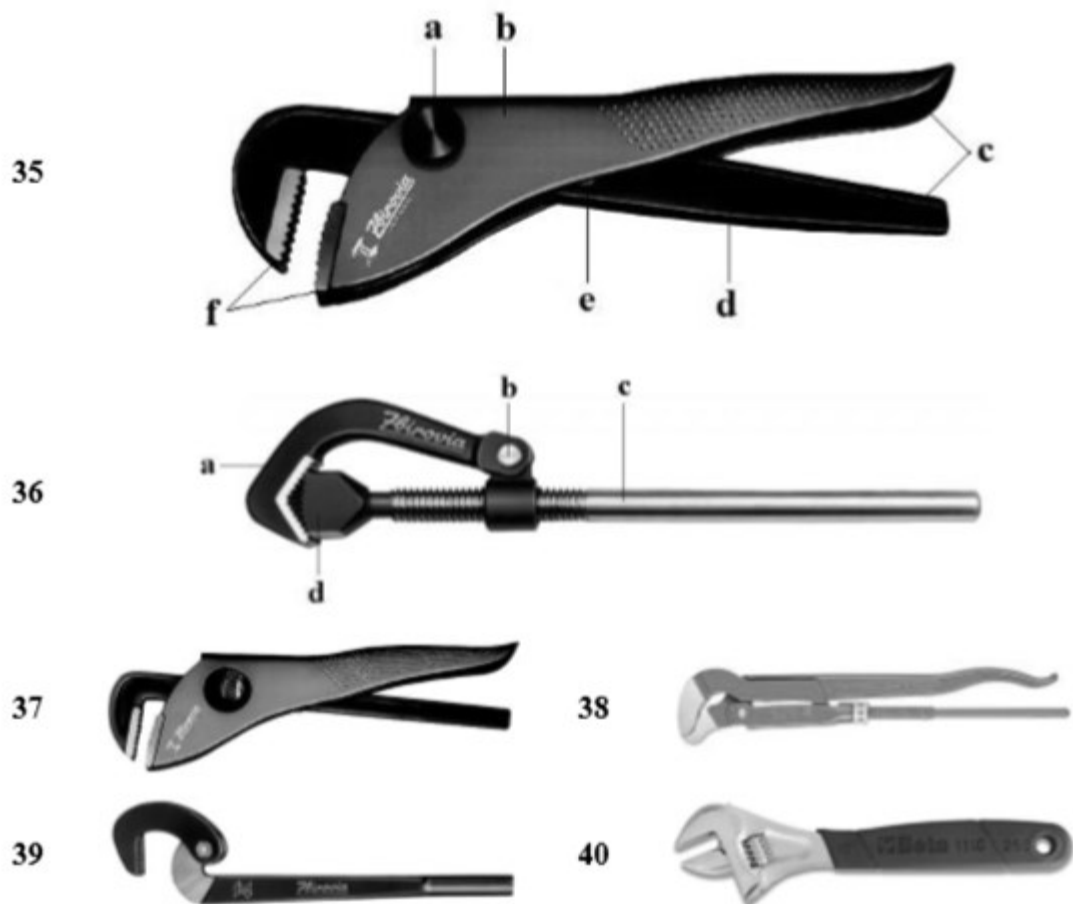
35 – hasák na trubky s přestavitelným šroubem (a – šroub [čep], b - plášť, c - rukojeti, d - tělo, e – otvor pro dřík šroubu, f – rýhované čelisti) , 36 – hasák kloubový (a - čelisti, b - matice, c - páka, d - hlava) , 37 – hasák na trubky s posuvnou maticí , 38 – hasák s pákovým převodem , 39 – hasák výstředníkový , 40 – klíč stavitelný se šnekem
