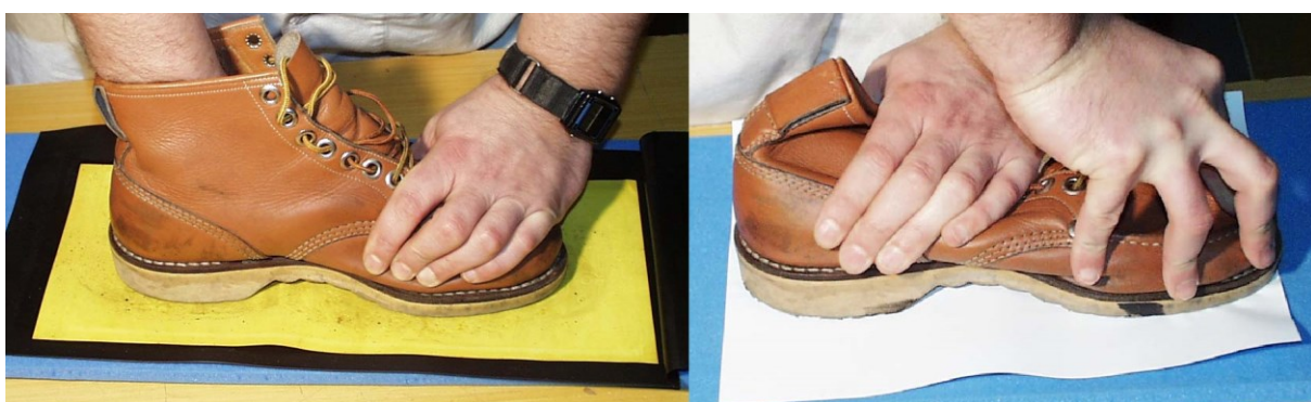
Obr. 6.3 - Použití soupravy pro nešpinavé snímání a otištění podešve na speciální papír.
