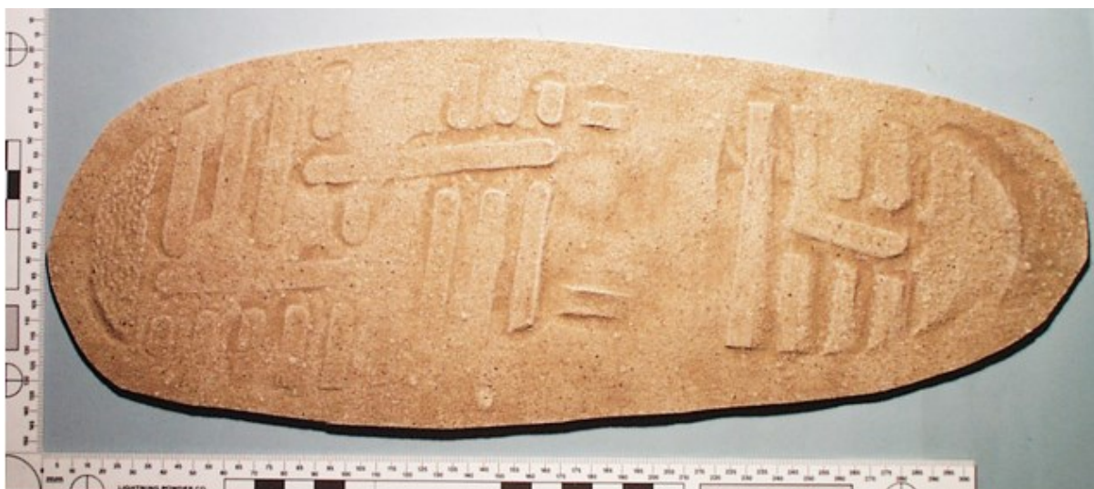
Obr. 5.10 - Lukoprenový odlitek stopy vytvořený v jemném písku na půdě (Straus, Porada a kol. 2004, s. 55).
