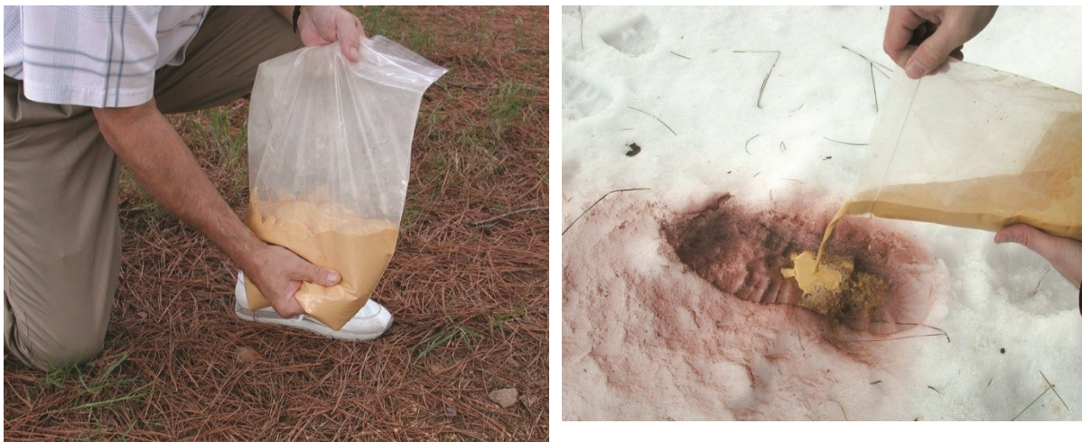
Obr. 5.12 - Postup při odlévání 3D trasologické stopy odlévací hmotou Dentalstone ([online]. In: [cit. 2019-05-17]. DOI: http://www.krimi-ltsezam.cz/cs/dentalstone-trasologicka-odlevaci-hmota/ ).
