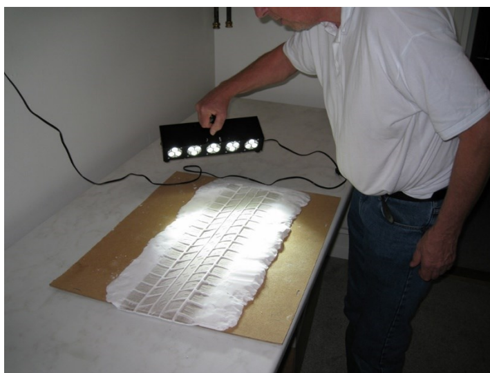
Obr. 6.8 - Postup při získávání srovnávacích otisků stop pneumatik ([online]. In: [cit. 2019-05-17]. DOI: http://es-trade.kiev.ua/en/mikrotrack.6X67M7/#&gid=1&pid=2 ).
