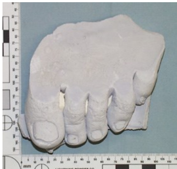
Obr. 5.14 - Odlitek bosé nohy zhotovený dentální odlévací hmotou YPPEN-PREMIUM.
