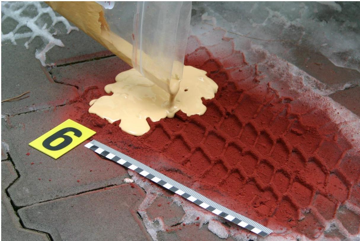
Obr. 5.13 - Odlévání trasologické stopy pneumatiky ve sněhu, odlévací hmota Dentalstone ([online]. In: [cit. 2019-05-17]. DOI: http://www.krimi-ltsezam.cz/cs/dentalstone-trasologicka-odlevaci-hmota/ ).
