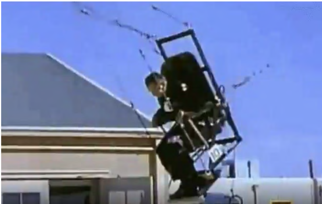
Obr. 3.25 - Kyvadlový zpomalovač. John Stapp jako figurant 70
