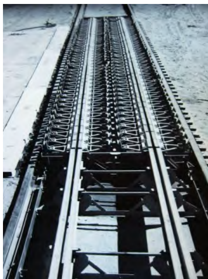
Obr. 3.33 - Hydraulické brzdy lineárního zpomalovače
