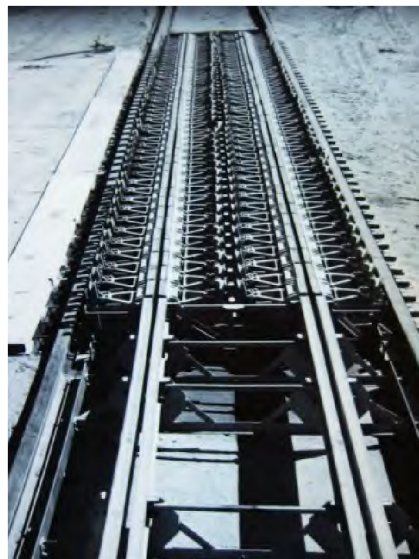
Obr. 3.33 - Hydraulické brzdy lineárního zpomalovače
