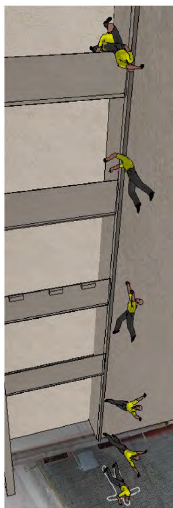
Obr. 5.15 - Verze aktivního působení druhé osoby, průběh pádu, výpočet s podporou simulačního programu Virtual Crash 4 (Straus)
