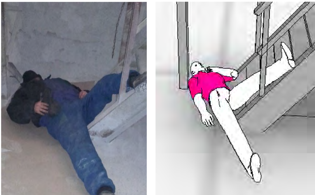
Obr. 5.19 - Finální poloha poškozeného podle výpovědi (vlevo) a poloha poškozeného podle počítačové simulace (vpravo)
