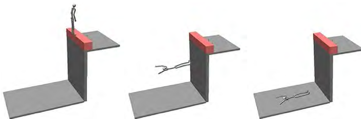
Obr. 5.29 - Počítačová simulace pádu muže, který stál na hraně pádu. V konečné poloze byl nalezen hlavou od svislice pádu, nohy blíže k místu pádu, konečná poloha v lehu na zádech. Při pádu se délková osa těla otočila o -90^\circ (vzad) 212
