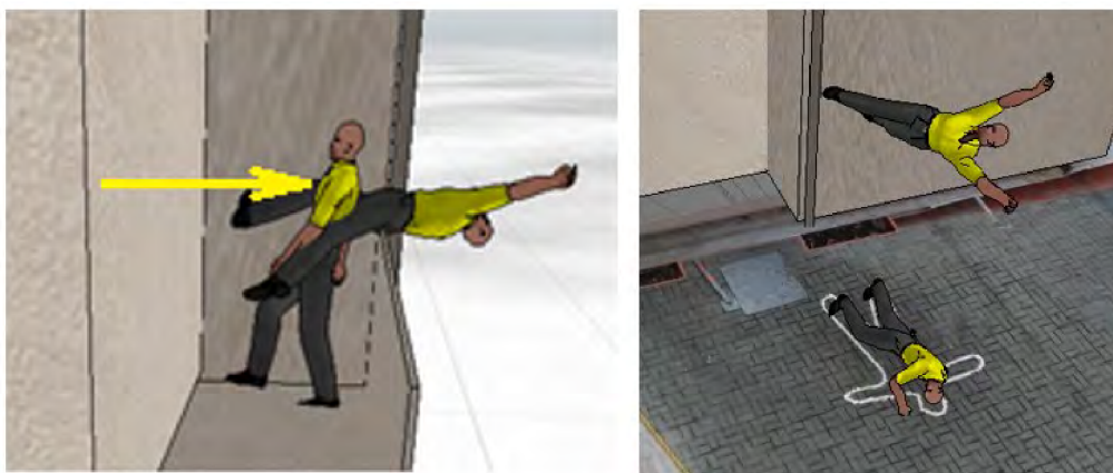
Obr. 5.13 - Verze aktivního působení druhé osoby, směr působící je síly vyznačen šipkou, počáteční fáze a konečná poloha, výpočet s podporou simulačního programu Virtual Crash 4 (Straus)
